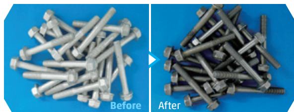
ボルト上のスズ亜鉛めっき除去 Stripping Tin-Zinc Alloy (Iron Bolt)
