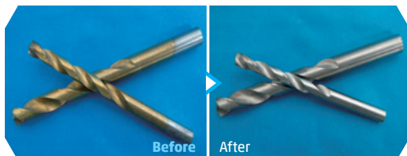
ハイス鋼の窒化チタン皮膜はく離 Stripping Titanium Nitride (High-speed Steel)
