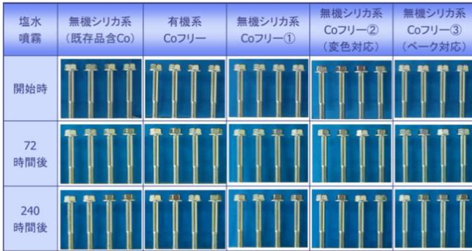
図9. 新規開発 Co フリー化成皮膜の耐食性（回転）
