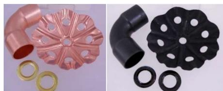
図1. 銅の黒染め処理前と処理後
